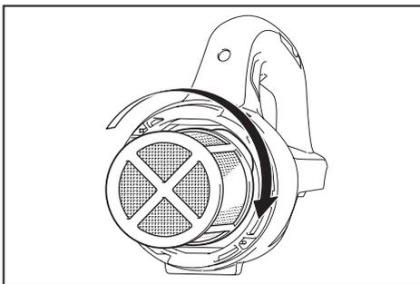
Instale a cápsula. Alinhe a marca na cápsula com a marca perto do cabo e gire a cápsula com firmeza no sentido da seta até que fique presa.
