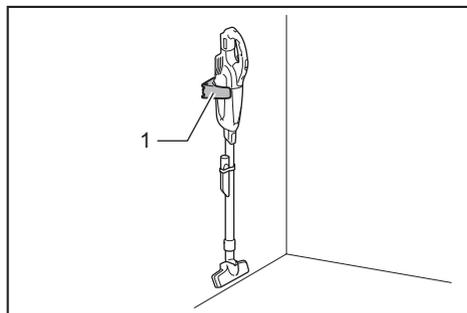
► 1. Suporte de parede do aspirador de pó a bateria
