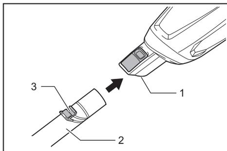
► 1. Entrada de sucção 2. Acessório com a função de travamento 3. Gancho
