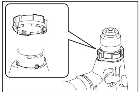
2. Instale o punho lateral (conjunto da base do punho opcional e o punho removido do punho lateral padrão) de modo que a ranhura do punho se ajuste à saliência do espaçador. Gire o punho no sentido horário para prendê-lo.
