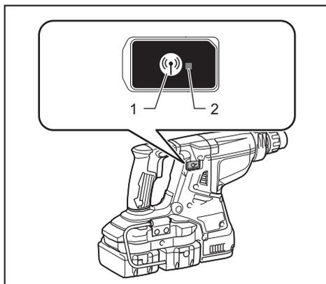
► 1. Botão da ativação sem fio 2. Lâmpada da ativação sem fio
