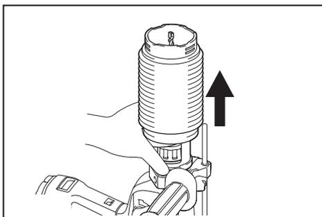
**NOTA:** Se a tampa do coletor de pó sair, prenda-a com o lado impresso voltado para cima, de forma que a ranhura da tampa se ajuste à abertura interna do acessório.
