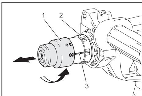
► 1. Mandril de encaixe rápido SDS-plus 2. Capa
