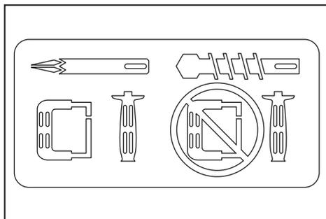
**⚠PRECAUÇÃO:** Utilize a empunhadura lateral somente para picagem, raspagem ou demolição. Não a use para perfurar concreto, alvenaria, etc. Não é possível segurar corretamente a ferramenta com esta empunhadura lateral para executar perfurações.
