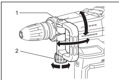
► 1. Empunhadura lateral 2. Porca de fixação
