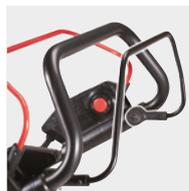
• Alavanca liga/desliga para função tracionado.
