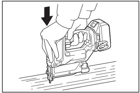
**NOTA:** Se a cabeça do pino ainda permanecer acima da peça de trabalho mesmo enquanto você segura o cabeçote do pinador, o material pode não ser adequado para o pinador. Continuar a usar o pinador com esse tipo de material poderá causar danos à lâmina do pinador e/ou o emperramento do pinador.
