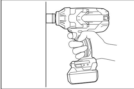
Segure a ferramenta firmemente e coloque o soquete de impacto sobre o parafuso passante ou a porca. Ligue a ferramenta e aperte durante o tempo de aperto adequado.
