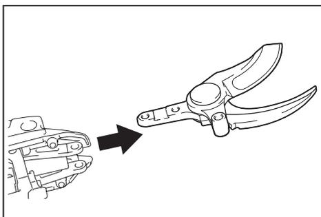
9. Para separar a lâmina superior da inferior, solte primeiro o parafuso passante de fixação da placa. Em seguida, remova a placa de travamento.
