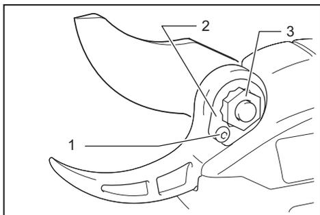
► 1. Parafuso passante de fixação da placa 2. Placa de travamento 3. Porca de aperto das lâminas
