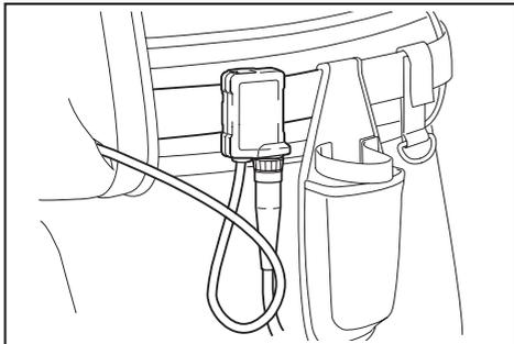
3. Passe o fio de conexão por dentro da presilha do suporte do fio.
