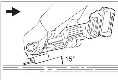
Ligue a ferramenta e coloque o disco sobre a peça de trabalho. Normalmente, mantenha a borda do disco em um ângulo de mais ou menos 15° em relação à superfície da peça de trabalho.
