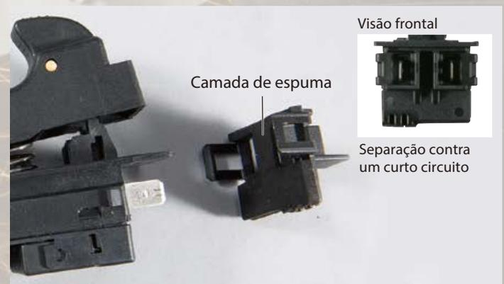
Evita a entrada de partículas de metal nos terminais melhorando a proteção contra curto circuito.
