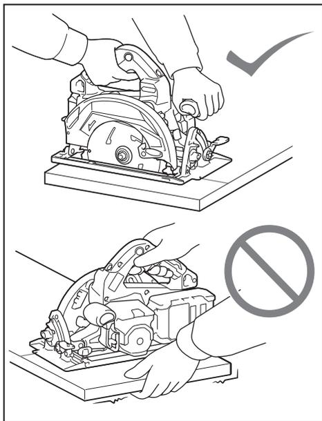
5. Antes de colocar a ferramenta de lado depois de terminar um corte, certifique-se de que o protetor de segurança está fechado e o disco completamente parado.
