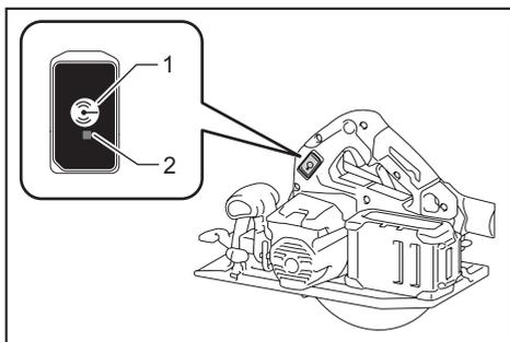
► 1. Botão da ativação sem fio 2. Lâmpada da ativação sem fio
