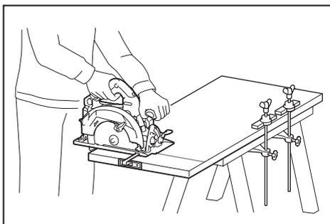
5. **Segure a ferramenta elétrica pelas superfícies isoladas ao executar uma operação em que a ferramenta de corte possa entrar em contato com fios ocultos.** O contato com um fio "vivo" também poderá carregar as partes metálicas expostas da ferramenta elétrica e causar choque elétrico no operador.
