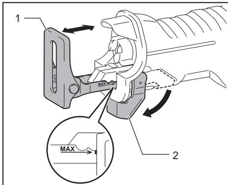
▶ 1. Sapata 2. Alavanca de ajuste da sapata
