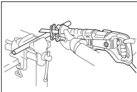
**OBSERVAÇÃO:** Não corte a peça de trabalho com a sapata afastada dela, ou sem a sapata. Fazer isso aumenta a força de reação, o que pode quebrar a lâmina da serra sabre.
