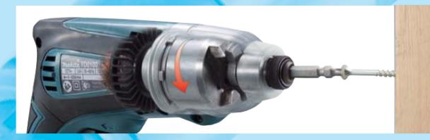
*O martelo é agora puxado para uma posição mais próxima do Motor e, finalmente, as partes salientes do Martelo deslizam para baixo da Bigorna, resultando na liberação da grande energia que ficou armazenada na Mola de Compressão e a energia liberada empurra e gira intensamente o Martelo.*
