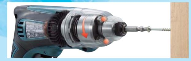
*Finalmente, o Matelo proporciona uma potência de impacto enorme na Bigorna, e a ferramenta aciona o parafuso com alto torque que a Energia de rotação sozinha não poderia produzir.*
