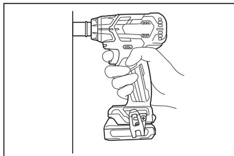
Segure a ferramenta firmemente e coloque o soquete de impacto sobre o parafuso passante ou a porca. Ligue a ferramenta e aperte durante o tempo de aperto adequado. O torque de aperto adequado pode variar dependendo do tipo ou tamanho do parafuso passante, do material da peça de trabalho que será apertada, etc. A relação entre o torque de aperto e o tempo de aperto está mostrada nas figuras.
