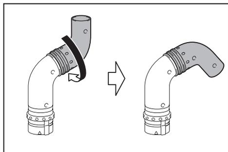
7. Conecte o bocal de extremidade ao tubo de extensão. Ao conectar, alinhe as marcas do triângulo no bocal de extremidade e no tubo de extensão e empurre o bocal de extremidade até ele fazer um clique. Em seguida, gire o bocal de extremidade colocando-o em uma posição adequada para o seu trabalho.
