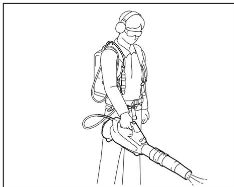
Para retirar a máquina, desengate a fivela da cinta de suspensão com uma das mãos enquanto segura a máquina com a outra.
