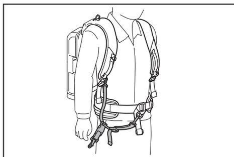
6. Conecte a correia de ombro à máquina usando o gancho da cinta de suspensão. Certifique-se de engatar no suspensor da máquina.
