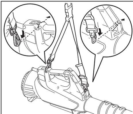
Ajuste o comprimento da cinta de suspensão conforme necessário.
