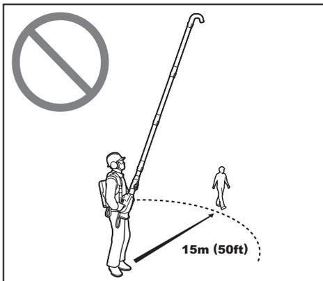
Segure o soprador pela empunhadura, mantendo-o na posição vertical. Coloque a saída do soprador na calha e ligue o soprador.
