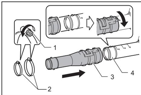
► 1. Parafuso 2. Abraçadeira de tubo 3. Tubo-adaptador 4. Tubo dianteiro
