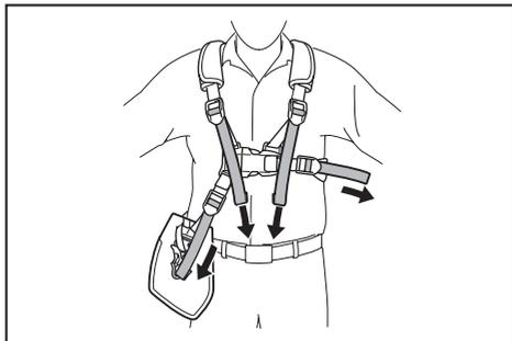
A correia de ombro possui um dispositivo de liberação rápida. Para soltar a ferramenta da correia de ombro, basta apertar as laterais da fivela enquanto segura a ferramenta.
