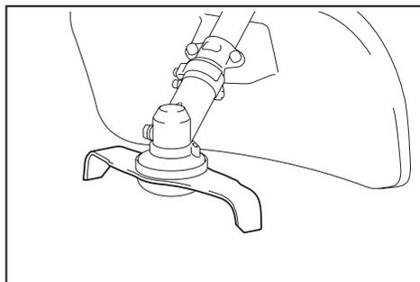
3. Coloque a arruela de aperto na lâmina do cortador e aperte a porca com firmeza usando a chave-sockete.
