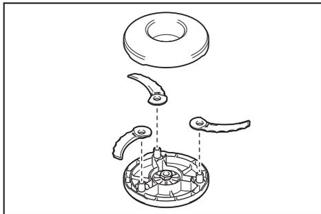
Ao instalar a lâmina de plástico, alinhe a direção da seta na lâmina à da seta no proteção.
