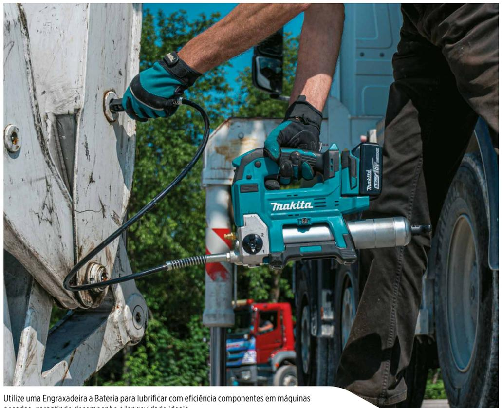
Utilize uma Engraxadeira a Bateria para lubrificar com eficiência componentes em máquinas pesadas, garantindo desempenho e longevidade ideais.
