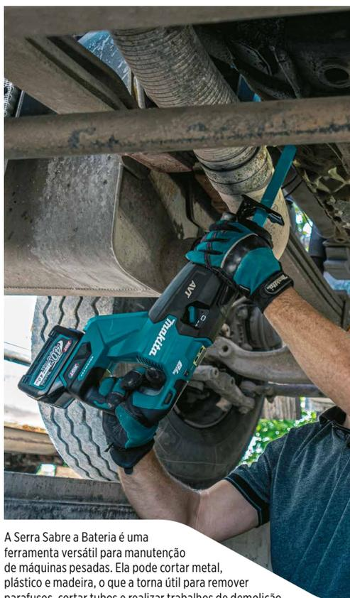
A Serra Sabre a Bateria é uma ferramenta versátil para manutenção de máquinas pesadas. Ela pode cortar metal, plástico e madeira, o que a torna útil para remover parafusos, cortar tubos e realizar trabalhos de demolição.
