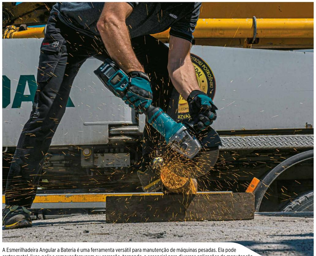
A Esmerilhadeira Angular a Bateria é uma ferramenta versátil para manutenção de máquinas pesadas. Ela pode cortar metal, lixar, polir e remover ferrugem ou corrosão, tornando-a essencial para diversas aplicações de manutenção.
