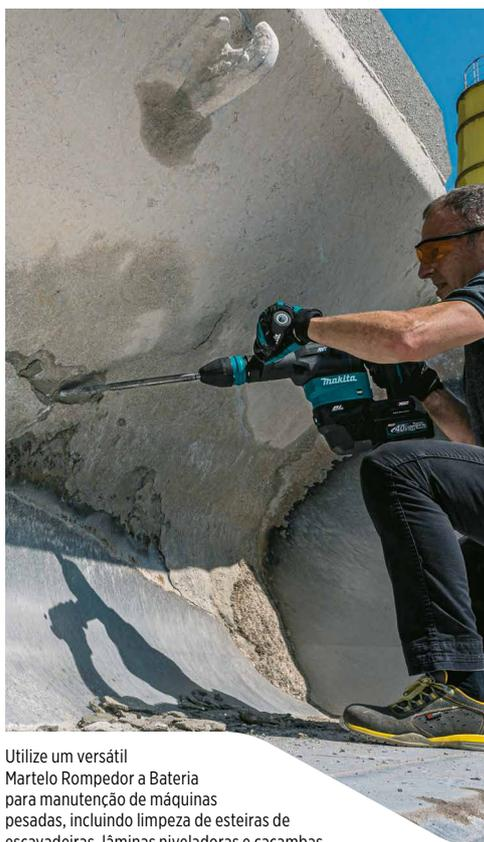
Utilize um versátil Martelo Rompedor a Bateria para manutenção de máquinas pesadas, incluindo limpeza de esteiras de escavadeiras, lâminas niveladoras e caçambas.
