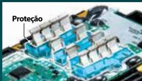
Estrutura de proteção dos circuitos e terminais
