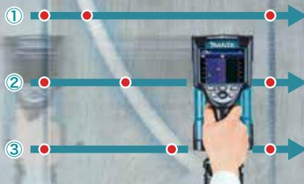
Segure o detector contra a superfície da parede.
